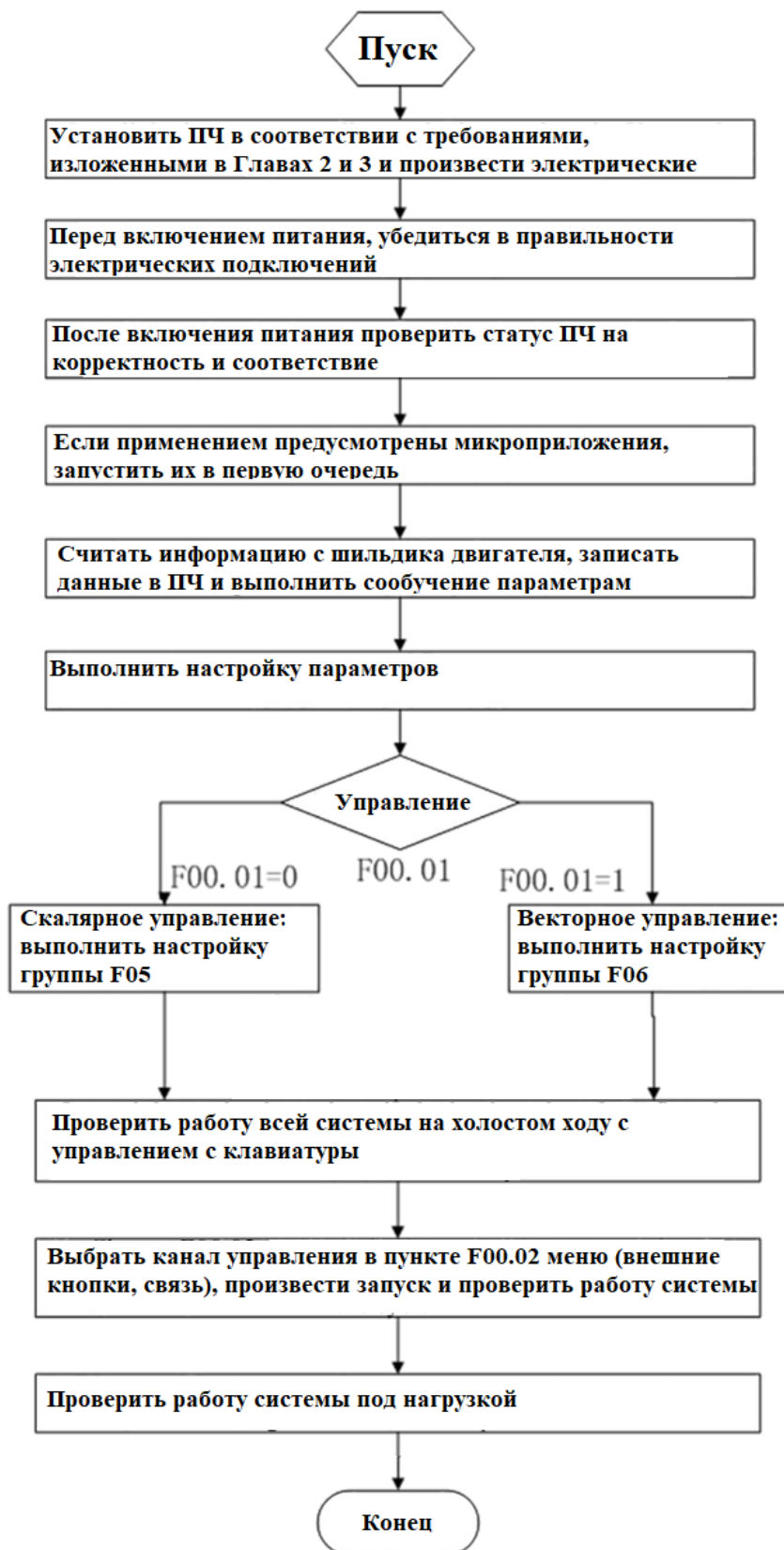
Рис. 5-1 Блок-схема процесса пуско-наладки ПЧ
